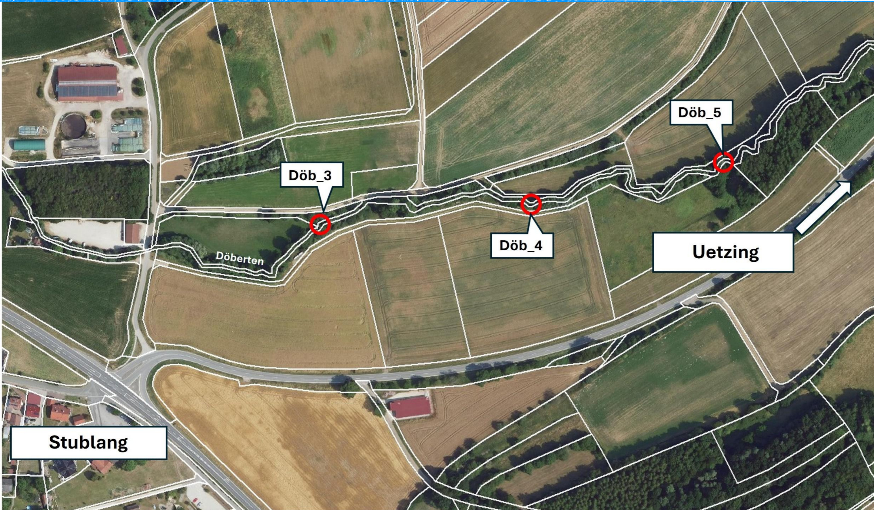
Übersicht der Wehre an der Döberten zwischen Uetzing und Stublang (Döb_3-Döb_5); die Abstürze an den drei Wehren sollen in passierbare Beckenpässe umgebaut werden
